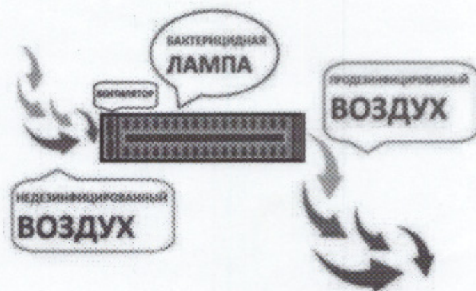
Рис. Принцип работы облучателя рециркулятора «AirRec»
